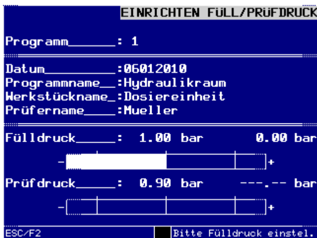
Dialogfenster Fülldruck des Prüfprogramms manuell einstellen
