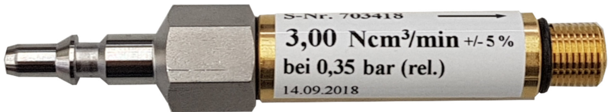
Abbildung 84: Testleck mit Stäubli Stecknippel
