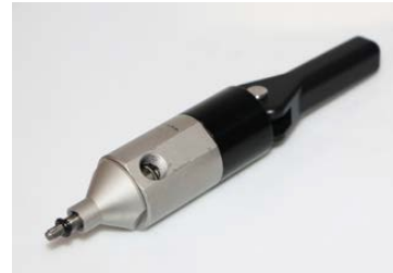
kleine Ausführung für M5-Gewinde
